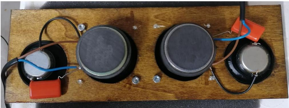
**Ilustración 33: Condensadores y cableado de los altavoces y Tweeters**
