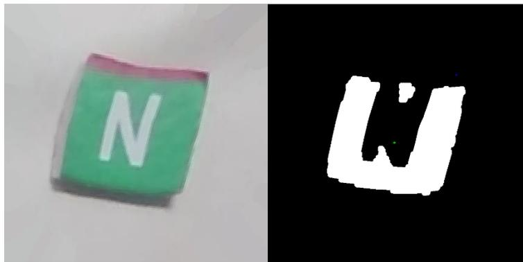
**Figura 35. Marcador OCR reconstruido no identificado.** A la izquierda, la imagen reconstruida sin alteraciones. A la derecha, el marcador mal binarizado por el brillo en la imagen.
