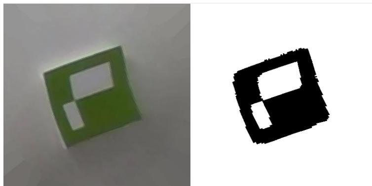
*Figura 30. Marcador ArUco reconstruido no identificado. A la izquierda, la imagen reconstruida sin alteraciones. A la derecha, el marcador binarizado, pero no identificado.*
