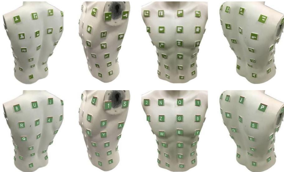
*Figura 12. Torso con los marcadores utilizados. En la parte superior, marcadores ArUco utilizados. En la parte inferior, marcadores alfanuméricos utilizados.*
