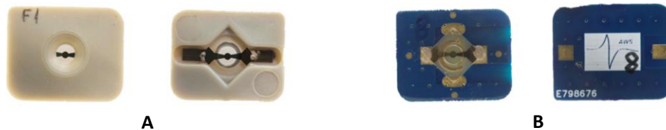
Figura 17. A) Sensor HFF-QCM montado sobre marco de PPS. B) Sensor HFF-QCM montado sobre soporte de PCB.
