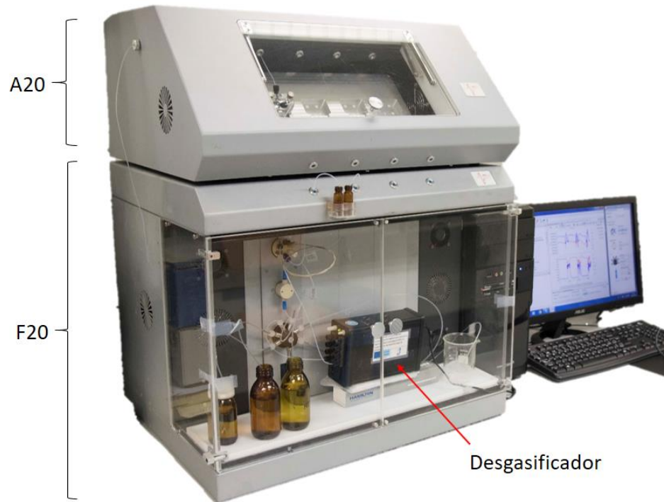
Figura 19. Plataforma de medida de sensores acústicos, integrada por el sistema de caracterización electrónica AWS A20 (bloque superior) y el sistema de microfluídica AWS F20 (bloque inferior).
