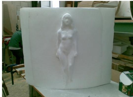
El último paso a seguir para construir la pantalla será la reproducción de la misma en resina epoxi (aplicada sobre fibra de vidrio). Modelaremos la forma encima del poliespan, empapando la fibra y estirándola hasta que quede bien ajustada.
