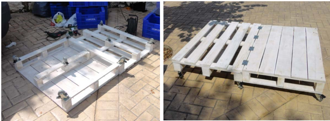
Imagen 75: Unión de palés con bisagras.
