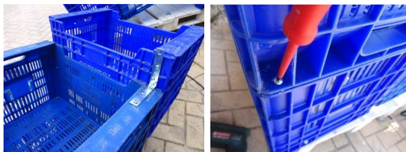
Imagen 76: Detalles de unión de las cajas 1.
