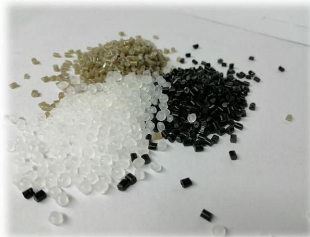
*Ilustración 68: Granzas base de polipropileno virgen y reciclado empleadas en el proyecto*
