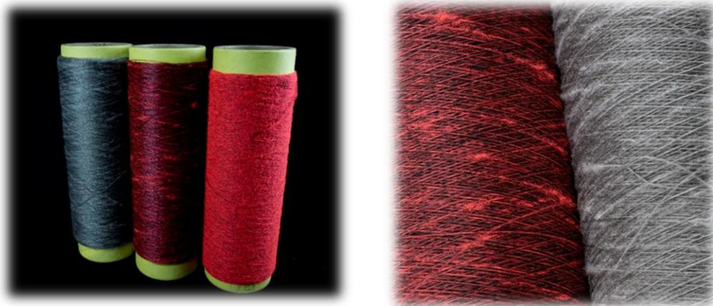
*Ilustración 70: Bobinas de hilos texturizados por aire TASLAN de rPP negro/gris combiandos entre sí y con hilo rojo*
