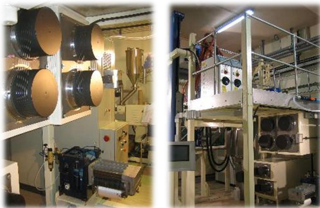
*Ilustración 25: Izq.) Rodillos de estiraje y relajación de la planta piloto hilatura por fusión multifilamento junto a la bobinadora Der) Plano general de la planta piloto de hilatura por fusión multifilamento*
