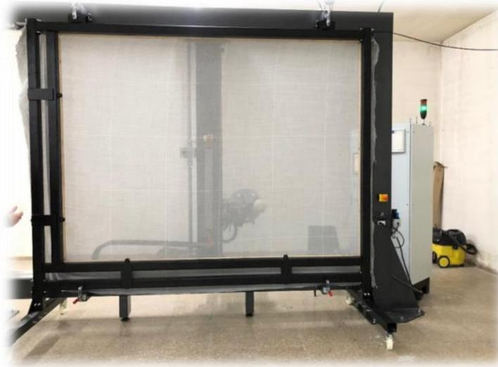
*Ilustración 32: Robot y marco de la planta experimental de Tufting*
