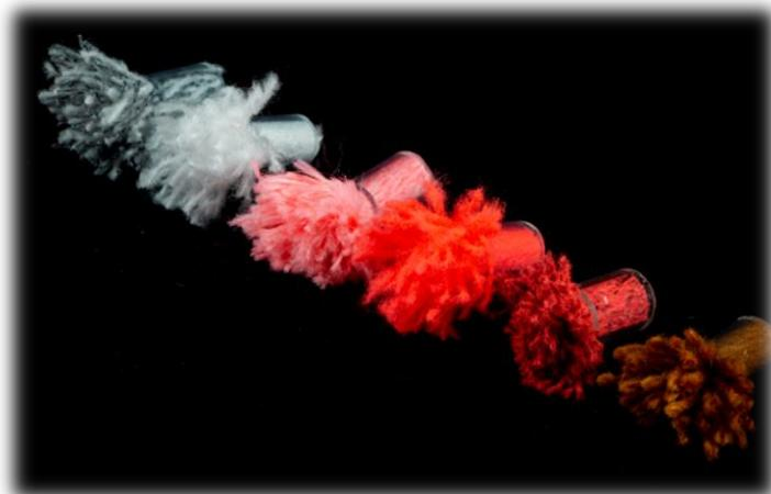
*Ilustración 71: Pompones de muestra de hilos obtenidos a partir del texturizado BCF*
