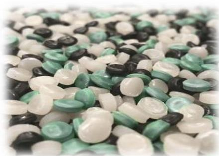
*Ilustración 18: Conjunto de pellets de granza de diversas materias recicladas y listas para un segundo procesado*
