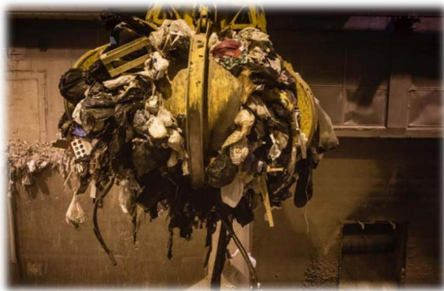
*Ilustración 9: Pala de vertedero recogiendo residuos acumulados*
