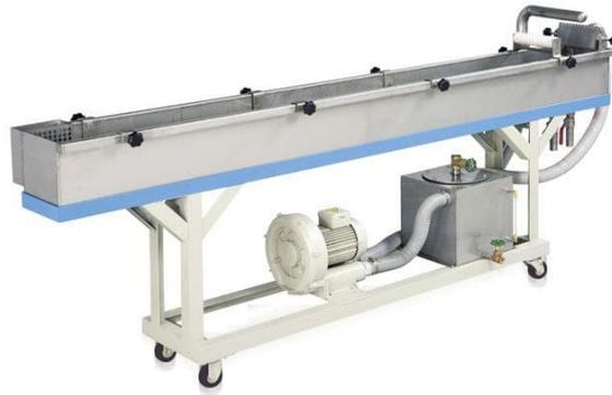
*Ilustración 22: Baño de refrigeración de la planta de compounding.*
