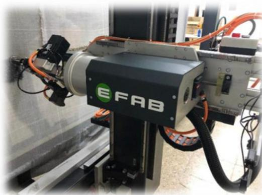
*Ilustración 33: Pistola de mechones mediante la que se realizan los prototipos de alfombras y moquetas.*
