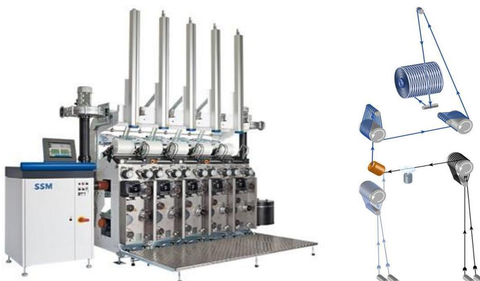
*Ilustración 26: Izq.) Planta de texturizado por chorro de aire (TASLAN). Der) Esquema de las diversas zonas del proceso de texturizado por chorro de aire (TASLAN)*
