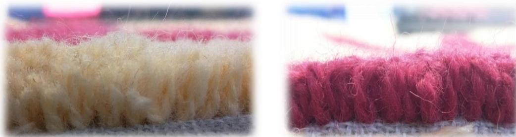
Ilustración 2: Diferenciación entre alfombra y moqueta en la sección transversal. a) Sección transversal de una alfombra, ya que cuenta con corte del "pelo". b) Sección transversal de una moqueta, ya que no se corta el hilo y tiene la forma conocida como "loop".
