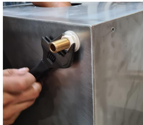
IMÁGEN 43: INSTERCIÓN DE COMPONENTES EN EL DEPÓSITO
