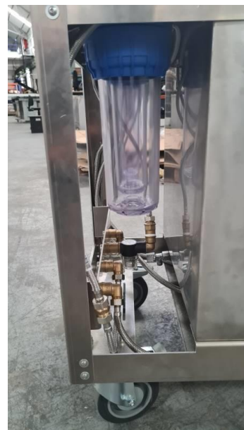
IMÁGEN 46: COLOCACIÓN PREFILTRO
