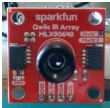
Ilustración 2: cámara termográfica o sensor de infrarrojos MLX90640 de SPARKFUN.
