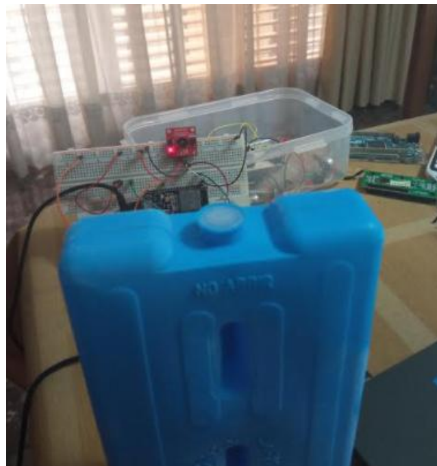
Ilustración 29: prueba de foco frío realizada con una placa de hielo. El foco se ubica en la parte inferior de la zona de barrido de la cámara termográfica.
