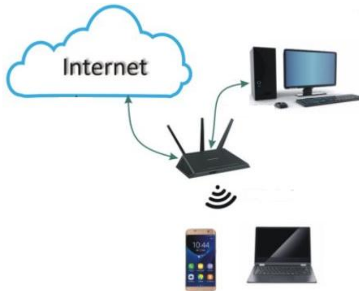
Ilustración 17: conexión de distintos dispositivos electrónicos a internet a través de un punto de acceso o router que genera la señal WiFi.
