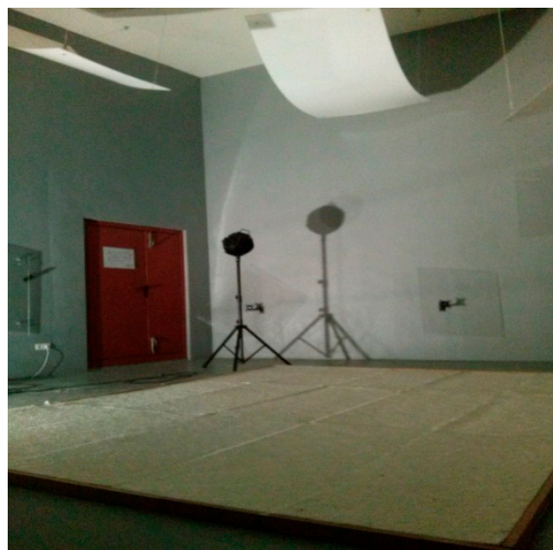
Figure 3. Normalized reverberation chamber at the EPS Gandia at the Universitat Politècnica de València.
