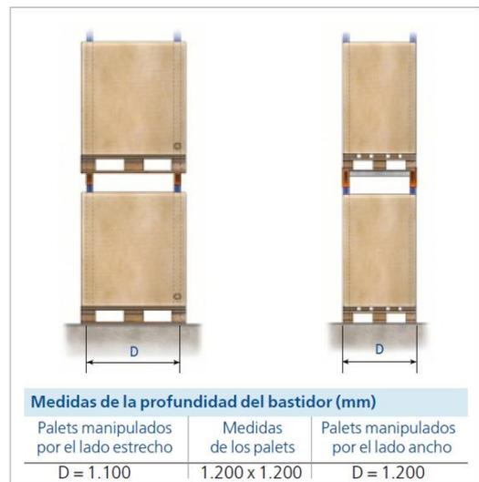
Figura 3.7. Medidas normalizadas de los pallets.
