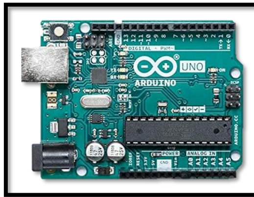
Ilustración 7. Placa de Arduino Uno R3. 16 pines digitales y 6 entradas analógicas. [5]
