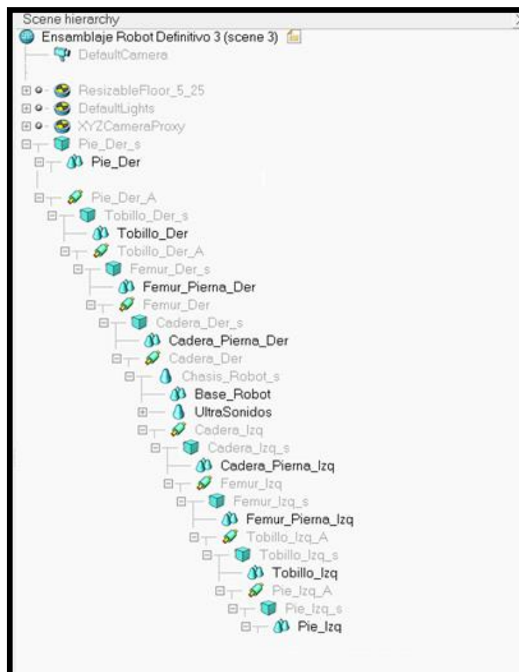
Ilustración 35. Jerarquía de todas las piezas y articulaciones del robot en CoppeliaSim.
