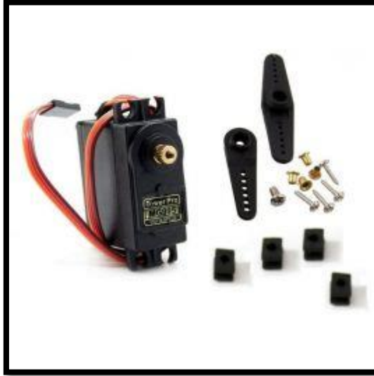
Ilustración 9. Servomotor MG995 con sus accesorios y tornillería necesaria. [7]
