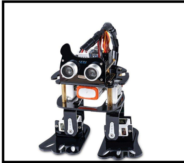
Ilustración 1. Ejemplo de robot bípedo, en este caso de 2 servos por pierna. [1]
