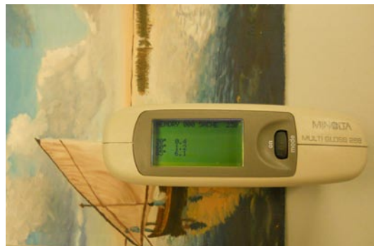
Fig.4.9.4 Medición del brillo
