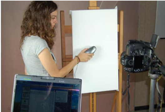
Fig.4.5.4 Medición de los datos colorimétricos espectrales del blanco patrón
