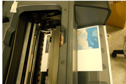
Fig.4.7.2 Impresión de la mitad de transferencia en Lazertran®
