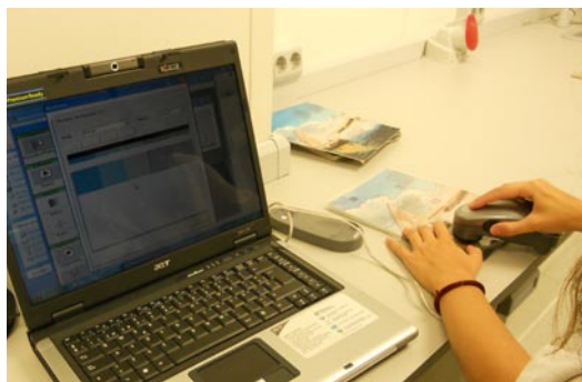
Fig.4.9.2 Toma de datos colorimétricos espectrales
