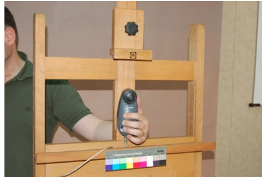
Fig.4.3.5 Medición de los datos colorimétricos espectrales de los iluminantes
