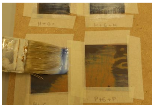
Fig.4.6.3 Adhición de Plextol B500 al Papelgel®
