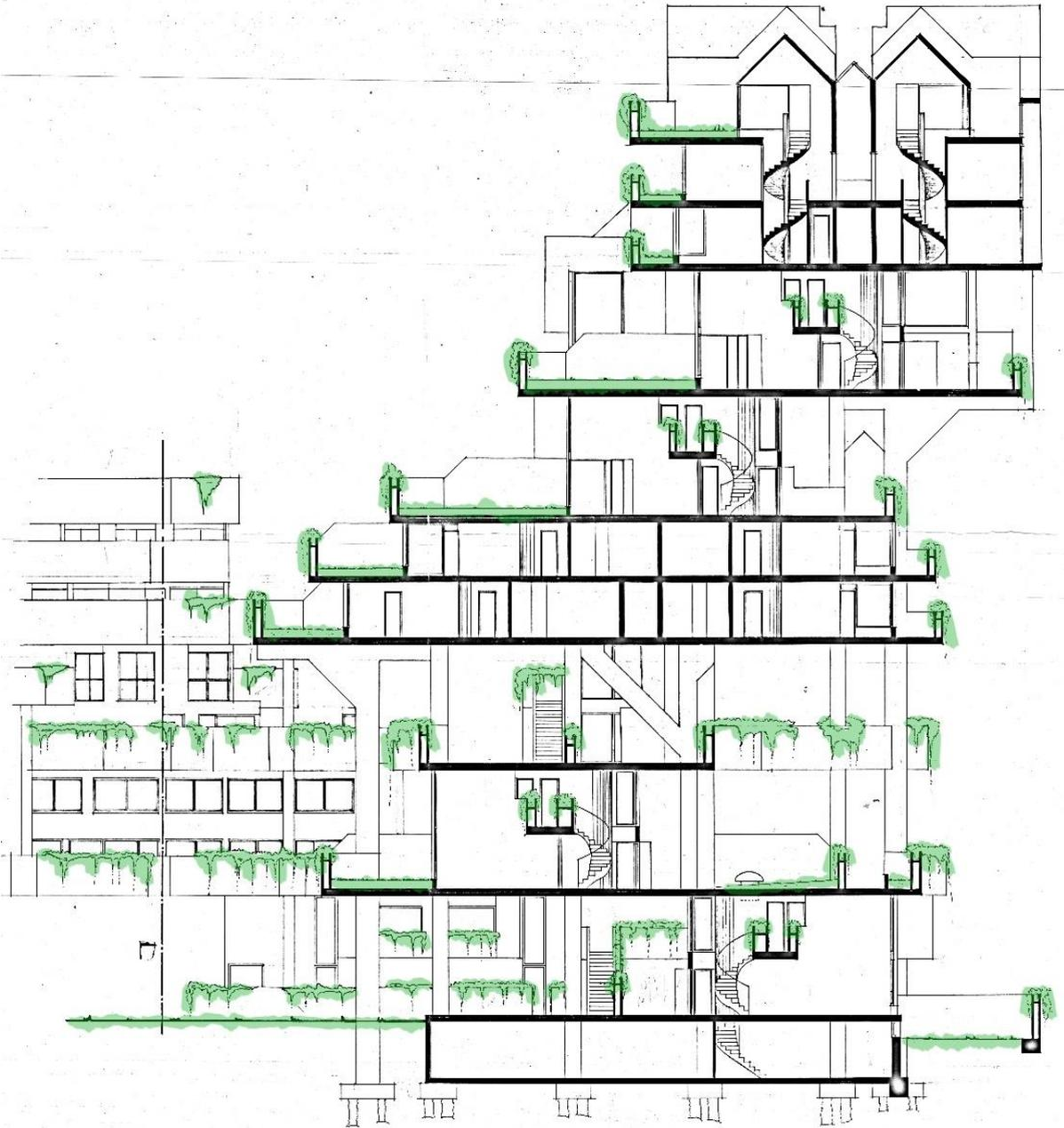
Figura O431. Sección original del proyecto con superposición de sombreados en las cubiertas vegetales y jardineras. Fuente: Dibujo del autor sobre sección original del archivo personal de Cortés.
