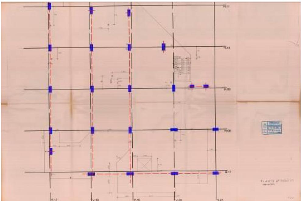
Figura 04.11. Plano estructural planta 4ª *Espai Verd* con superposición de la trama y ejes de estructura. Fuente: Dibujo del autor sobre plano de estructura del archivo personal de Cortés.
