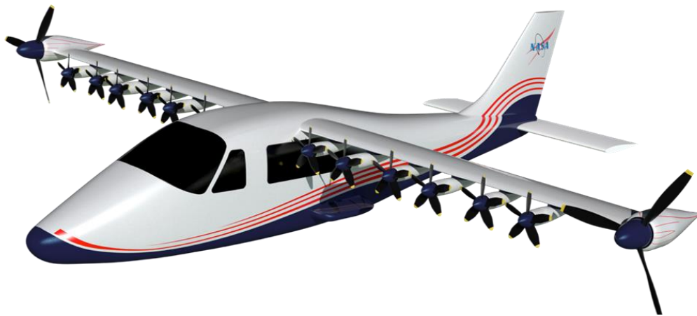
Figura 2.15. X-57 Maxwell, aeronave de ala fija con DEP [31]
