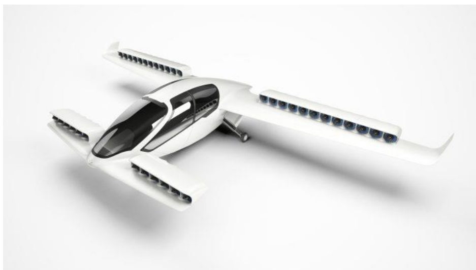
Figura 2.17. Lilium Jet, aeronave con los motores dispuestos en el borde de salida [34]
