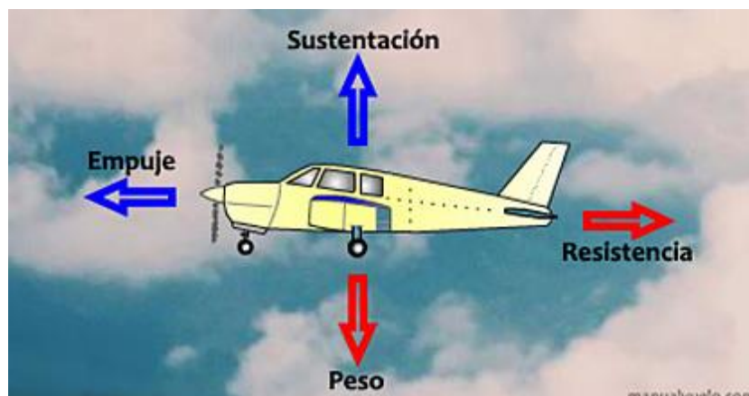
Figura 2.10. Esquema de fuerzas actuantes sobre una aeronave de ala fija [27]
