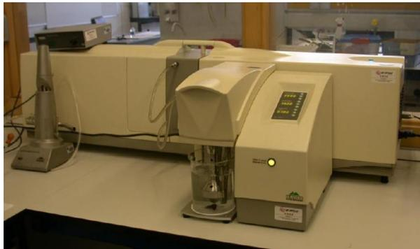
Figura 36: Equipo de medida de tamaño de partícula mediante láser.
