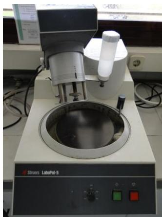
*Figura 60: Pulidora automática Struers LaboPol-5.*
