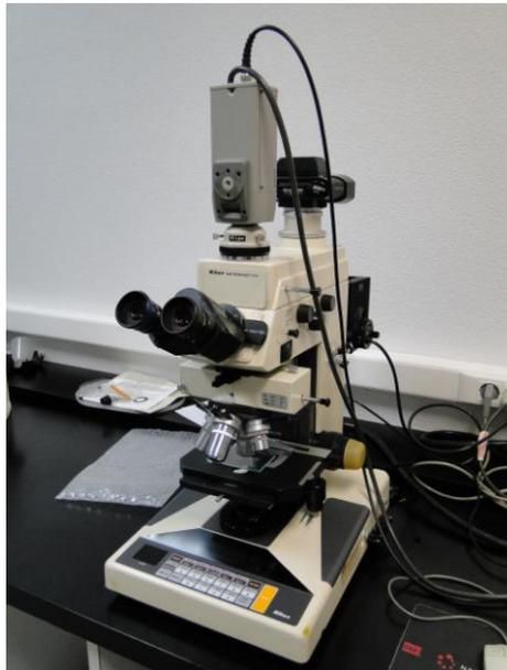
*Figura 61: Microscopio metalográfico Nikon Microphot FX.*
