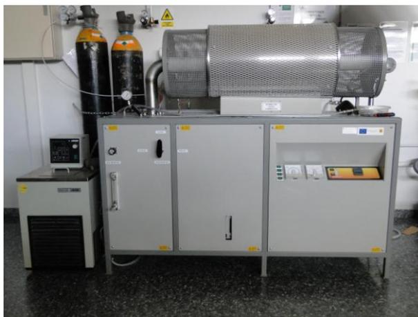
*Figura 47: Horno Carbolite de vacío modelo HVT 15/75/450*
