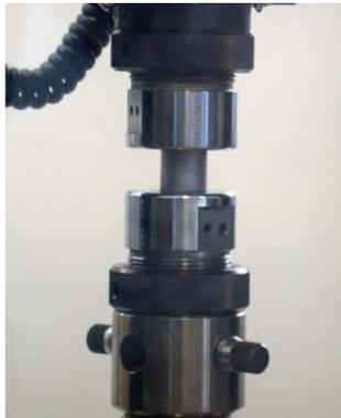
*Figura 52: Detalle de montaje para ensayo de compresión.*
