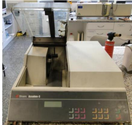
Figura 57: a) Cortadora de precisión Struers Accutom-5.
