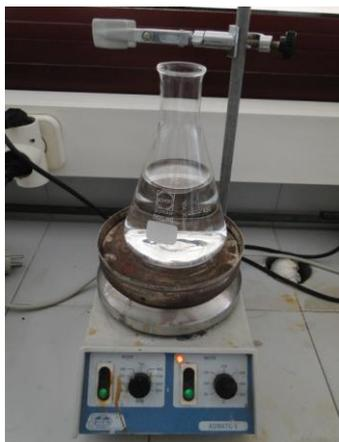
*Figura 54: Agitador magnético Selecta modelo Agimatic-E.*
