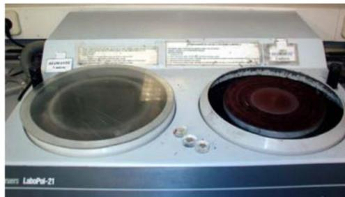
*Figura 59: Desbastadora/pulidora de discos giratorios Struers LaboPol-21.*
