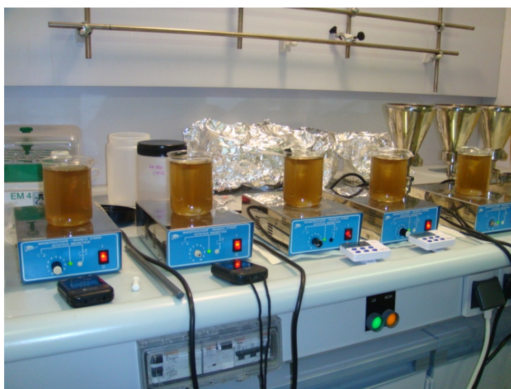
Figura 18: Imagen del jar test. Reacción con polielectrolito
