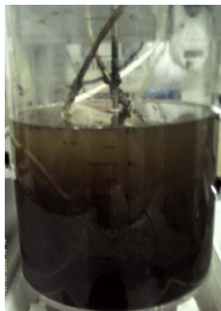
Figura 32: Imagen de la fase de decantación en el SBR con dosificación de polielectrolito CH-30
