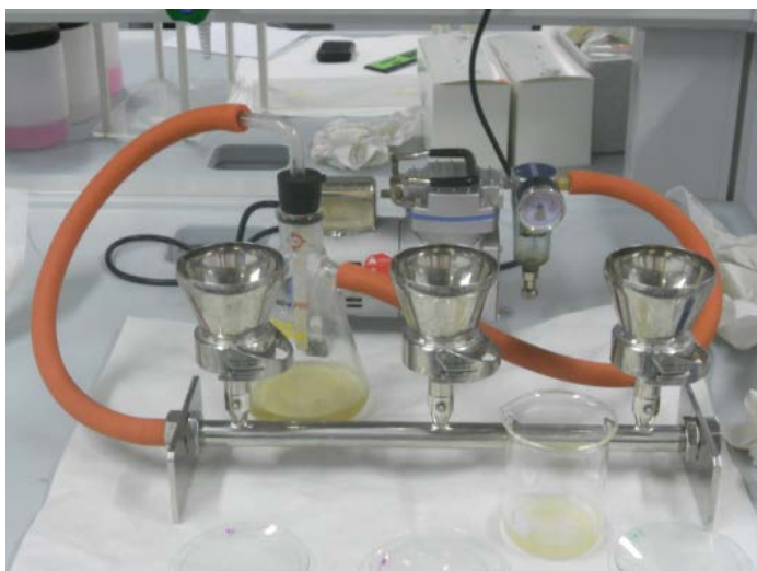
Figura 9: Montaje para la filtración de sólidos
