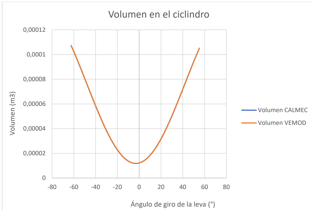
Figura 6.2.2. Volumen en el cilindro durante el ciclo cerrado a 2000 rpm
