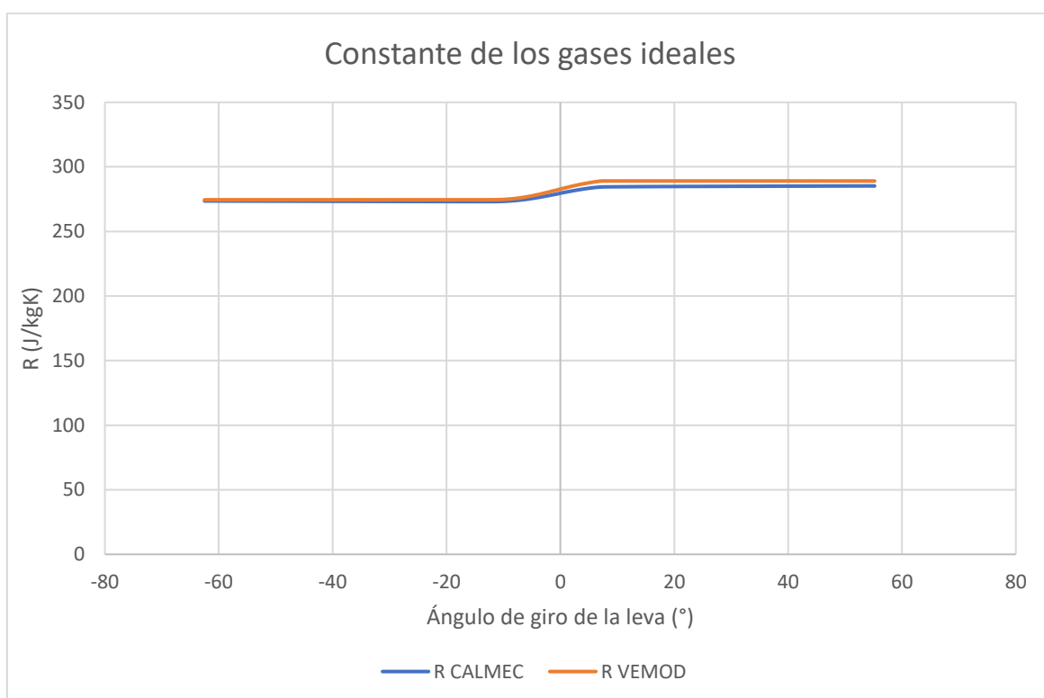
Figura 6.2.10 Constante de los gases ideales durante el ciclo cerrado a 2000 rpm
