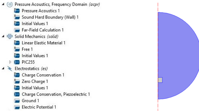
Figura III.32. Interfases físicas empleadas por el modelo FEM para el cálculo del RVR.
