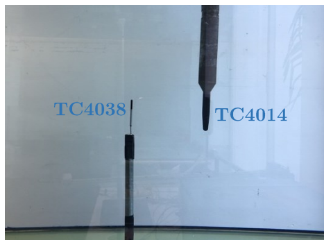
Figura IV.28. Posición inicial para el receptor partiendo desde el centro hasta el primer punto de medida.
