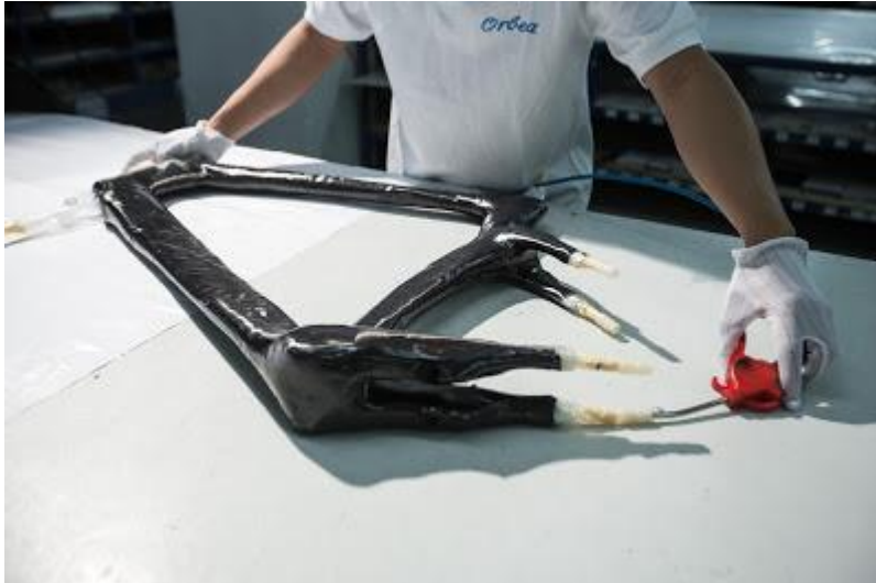
Ilustración 138. Conjunto de perfiles tras el horneado. Fuente: think-mtb.blogspot.com
