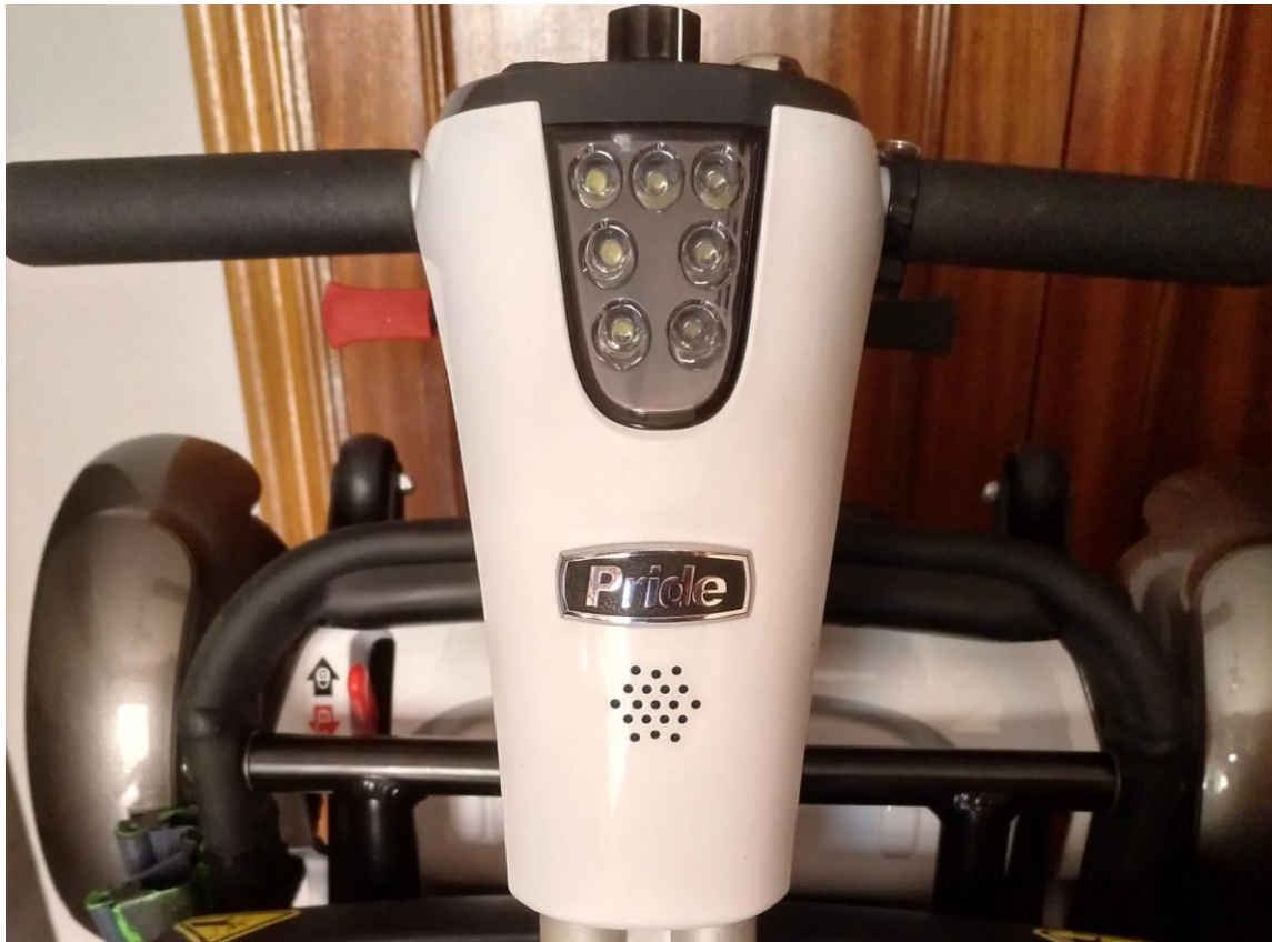
Ilustración 32. Unión columna de dirección con panel de control.
