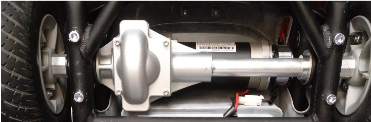
Ilustración 25. Eje motriz y unión con ruedas traseras.
