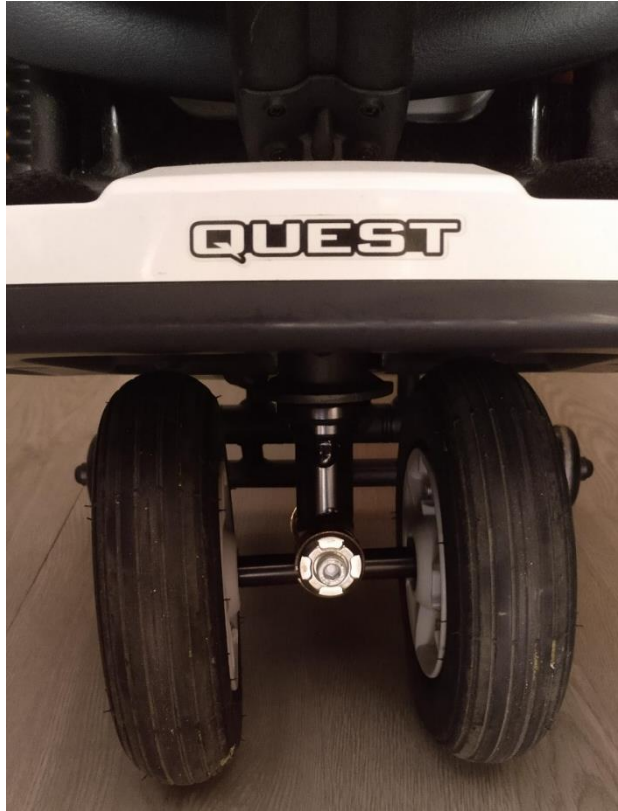
Ilustración 30. Unión columna de dirección con ruedas delanteras.
