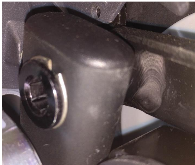
Ilustración 12. Unión estructura del asiento con la parte trasera del chasis.
