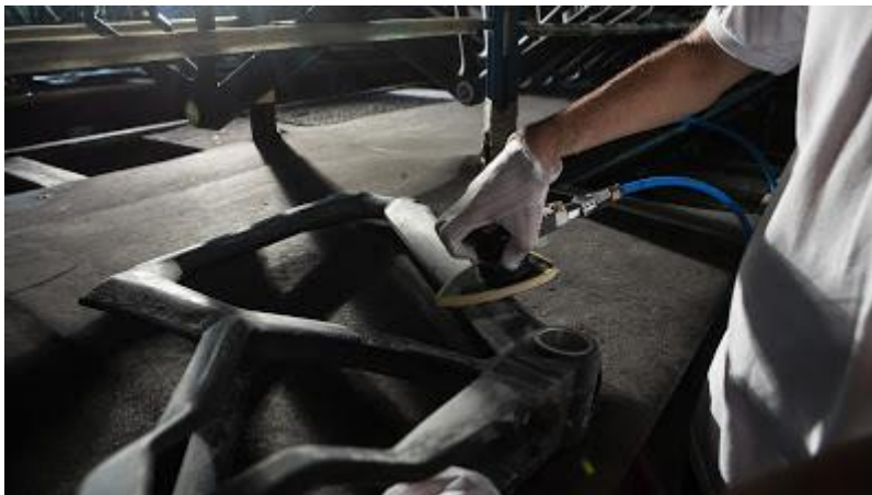
Ilustración 137. Operaciones de acabado del conjunto de perfiles. Fuente: think-mtb.blogspot.com
