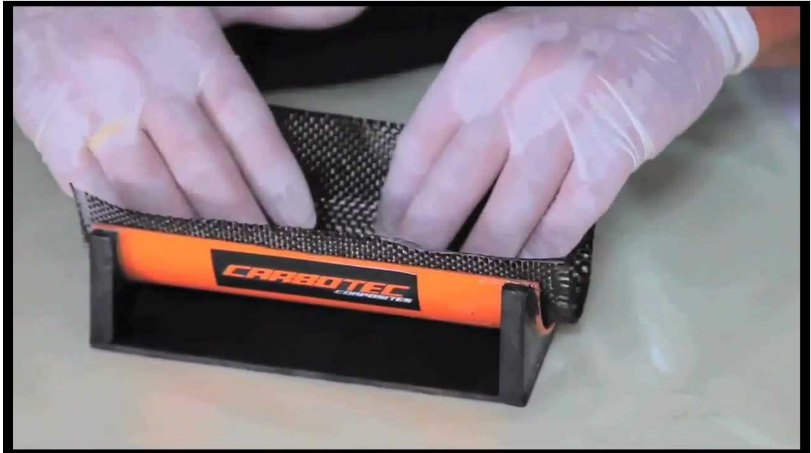
Ilustración 135. Colocación pieza de pre-preg de fibra de carbono en el molde. Fuente: youtube.com/watch?v=IGCqblcYdlw
