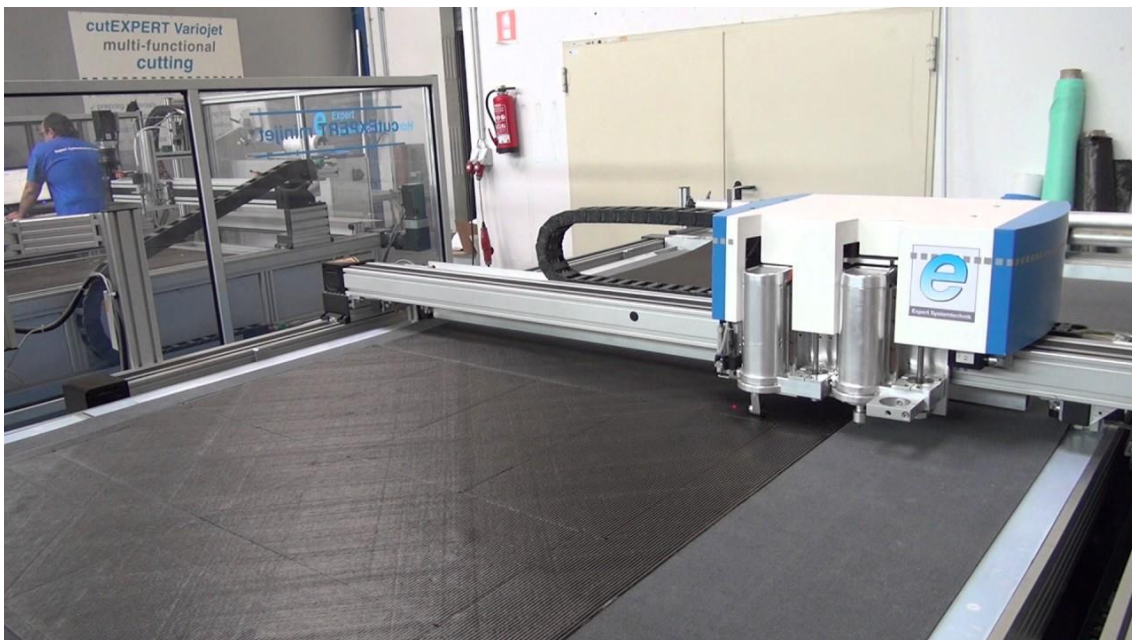
Ilustración 134. Operación de corte de las láminas de fibra de carbono. Fuente: youtube.com/watch?v=jz6yDbhF0G0
