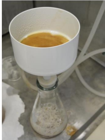
Imagen 35. Película obtenida por el método de filtrado, aplicando vacío [87]
