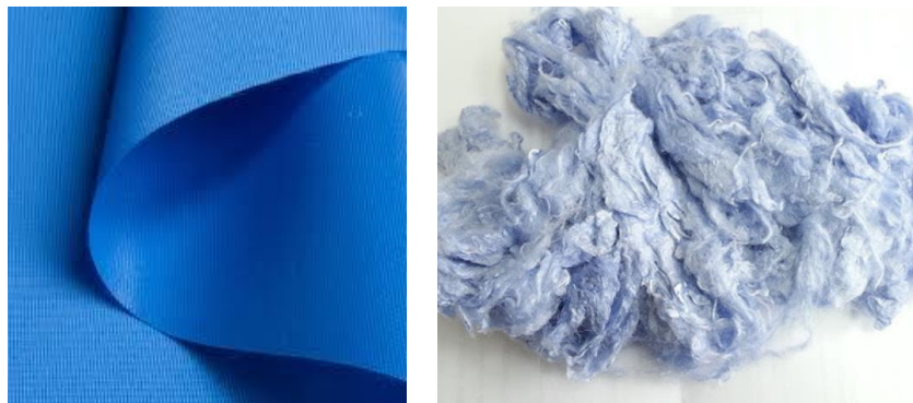
Imagen 32. (De izqda. a drcha.) Tejido de poliéster - Fibra de rayón de viscosa [82][83]
