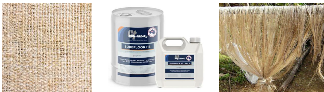
Imagen 30. (De izq. a drcha.) Tejido de yute, resina (matriz del material compuesto) y fibras de yute (refuerzo del material compuesto) [76][77][78]
