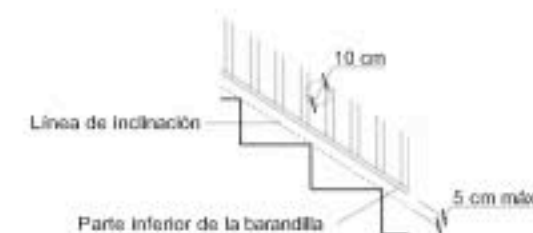
Figura 3.2 Línea de inclinación y parte inferior de la barandilla
