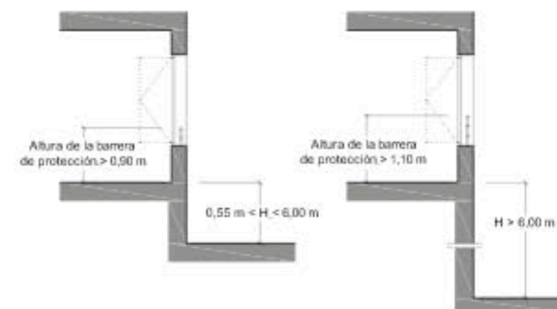
Figura 3.1 Barreras de protección en ventanas.
