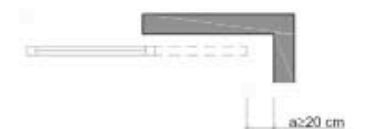
Figura 2.1 Holgura para evitar atrapamientos
