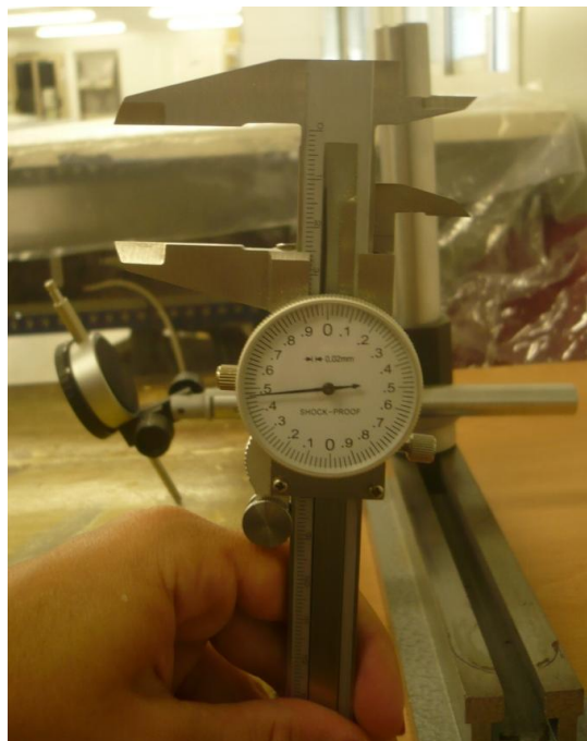
Fig. 32. Calibrador con indicador de carátula.
