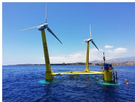
Figura 7. Prototipo Wind2Power instalado en Gran Canaria. Fuente: Wip10plus.
