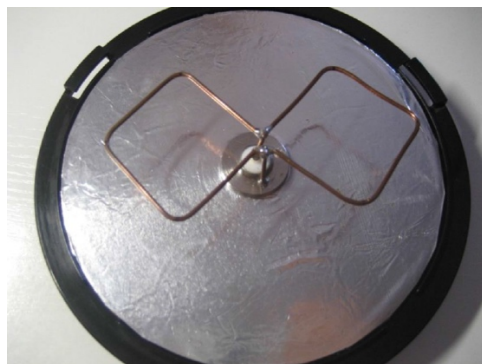
Figura 5. Ejemplos de antenas fabricadas por los estudiantes a partir de materiales reciclados.
