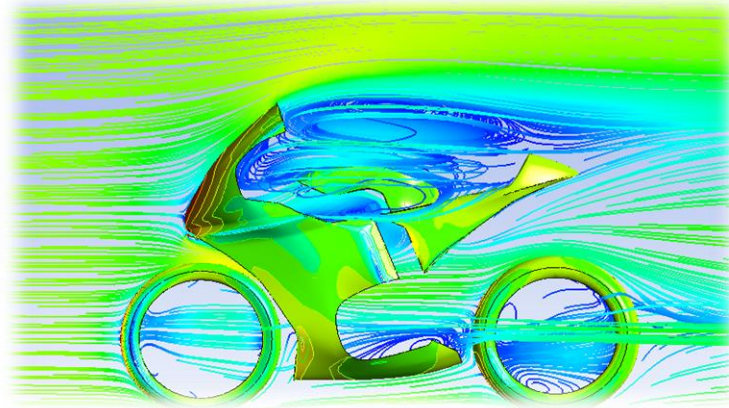
Ilustración 22: Trayectorias del aire y su incidencia en el carenado
