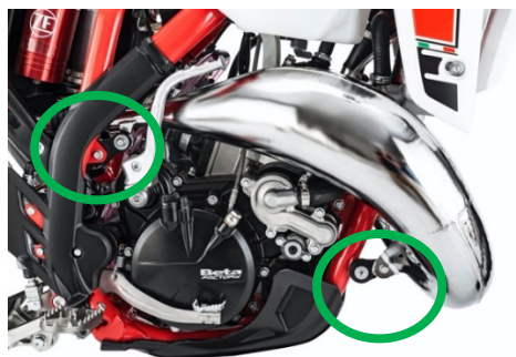
Figura III.23. Puntos de anclaje fijos del sistema de escape con el chasis de la motocicleta 46 .
