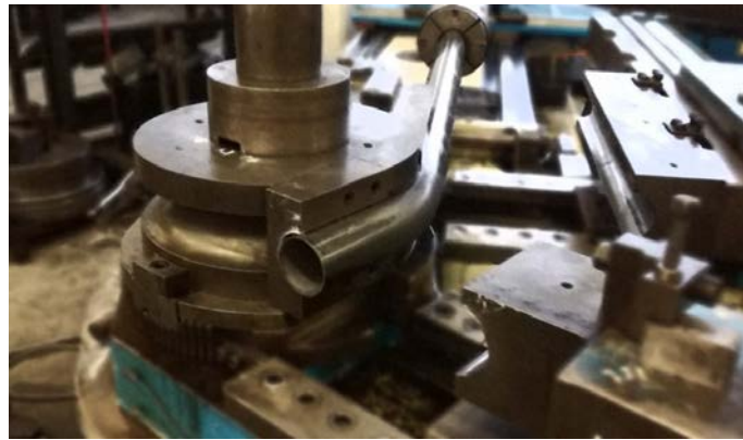
Figura III.42. Proceso de curvatura de tubos para la parte del codo y de la caña del sistema de escape 54 .
