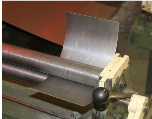
Figura III.45. Proceso de doblado de las chapas de acero para formar los diferentes conos 57 .
