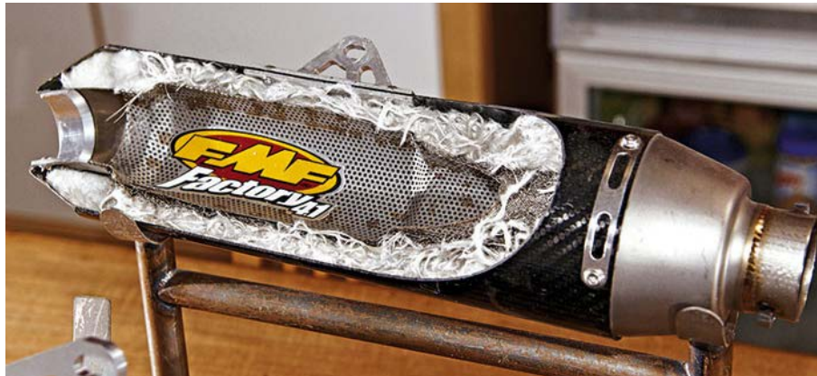
Figura I.32. Partes del interior del silenciador de un tubo de escape 33 .
