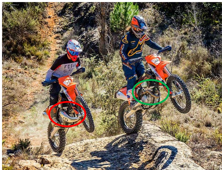
Figura I.36. Imagen de la diferencia entre el sistema de escape de una moto de dos tiempos (2T) y una de cuatro tiempos (4T) 37 .
