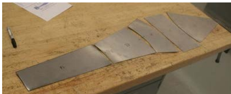
Figura III.44. Las piezas que conforman el escape una vez han sido cortadas de la plantilla 56 .
