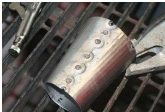
Figura III.46. Proceso de soldadura por puntos para unir en un primer momento los diferentes conos 58 .
