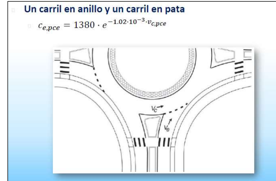
Figura 87: Expresión para obtener la capacidad en glorieta de un carril (Poliformat)
