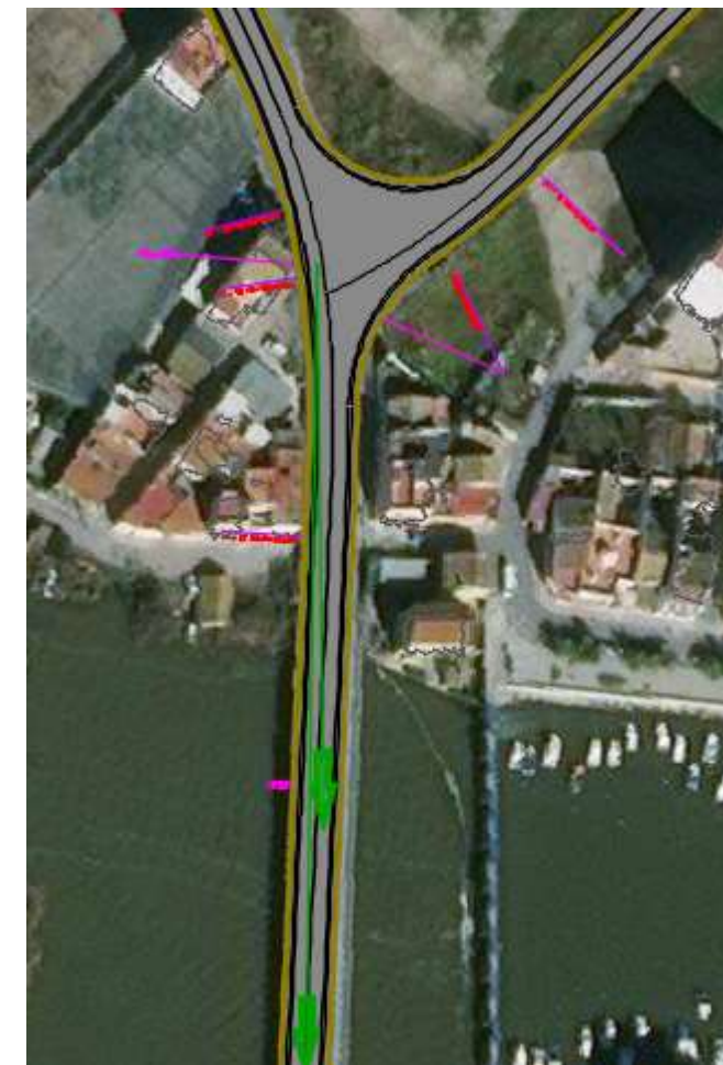
Figura 37: Simulación de la visibilidad de cruce en maniobras de giro a la izquierda desde la vía principal (AutoCAD Civil 3D)
