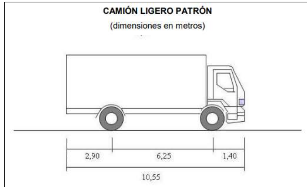
Figura 17: Dimensiones vehículo patrón de la situación actual (3.1 IC Trazado)
