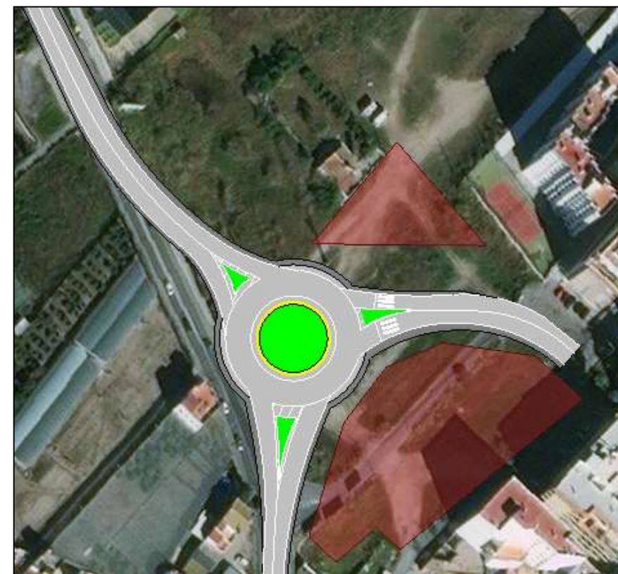
Figura 85: Espacio disponible para aparcamientos de la alternativa 1 (Elaboración propia, AutoCAD Civil 3d)
