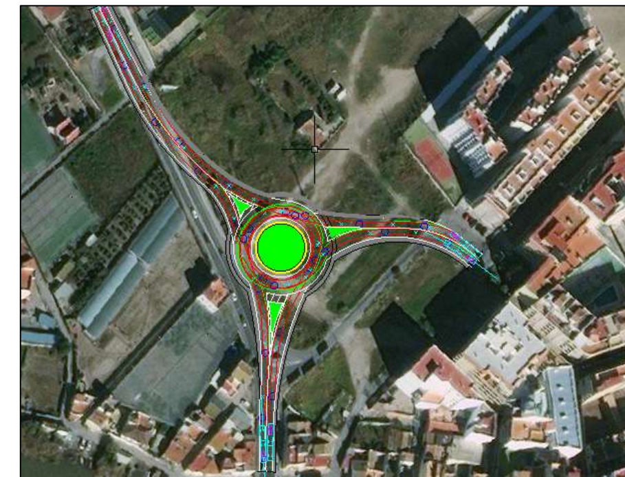
Figura 80: Trayectorias del vehículo patrón en la alternativa 1 (Elaboración propia, AutoCAD Civil 3d)
