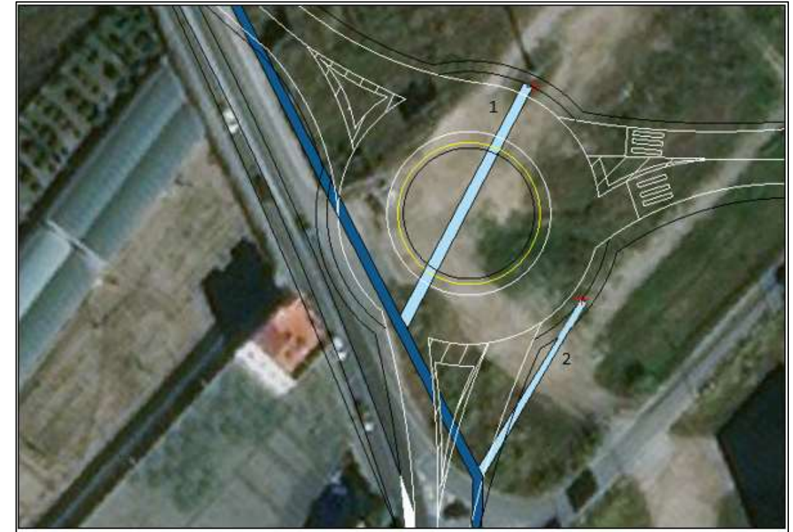
Figura 92: Obras de drenaje alternativa 1 (elaboración propia, AutoCAD)
