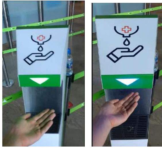
Fig. 77 cambio indicador luminoso al dispensar la dosis.
