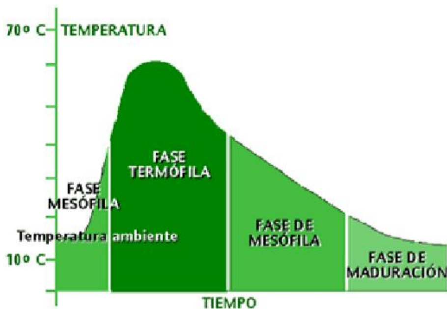
Ilustración 4 Temperatura VS tiempo de las diferentes fases del proceso
