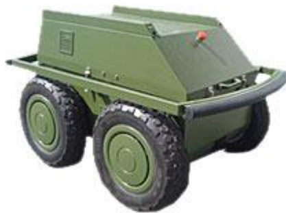
Figura 15: Robot rodante dotado de 4 ruedas en configuración 2+2
