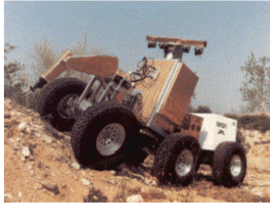
Figura 17: Robot rodante de 6 ruedas con dirección independiente frontal y trasera
