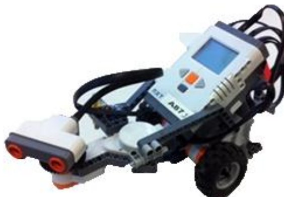
Figura 73. Robot LEGO configuración diferencial
