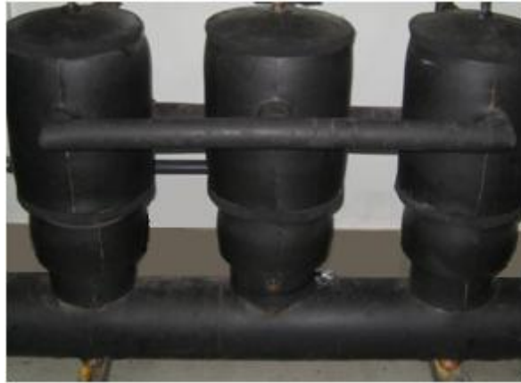
Figura 2.4. Calorímetro calorifugado con refrigerante secundario R134a.
