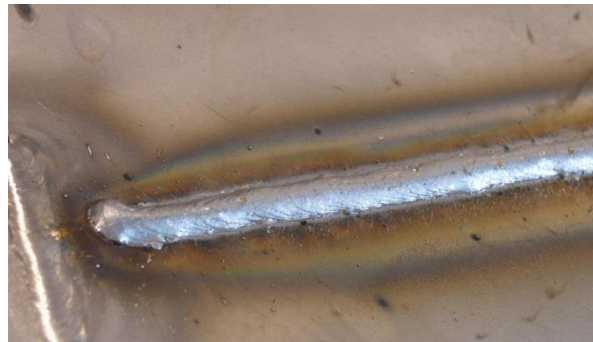
Ilustración 26. Cordón de soldadura
