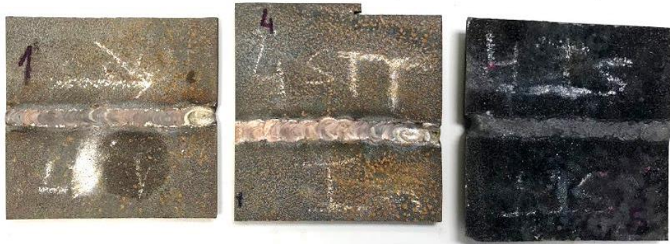
Ilustración 34. Resultado final piezas soldadas
