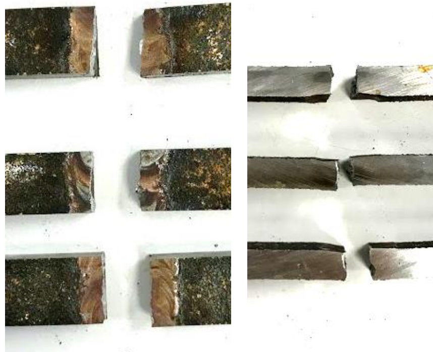
Ilustración 67. Probetas sin tratamiento térmico ensayadas a tracción
