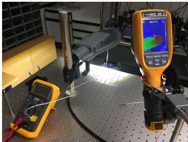
Figura 25: Sistema empleado para realizar las mediciones de temperatura en la luminaria para alumbrado público [2] .
