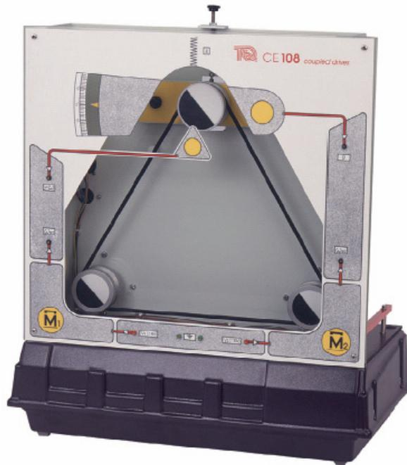
Fig. 3.8: Sistema de motores acoplados.
