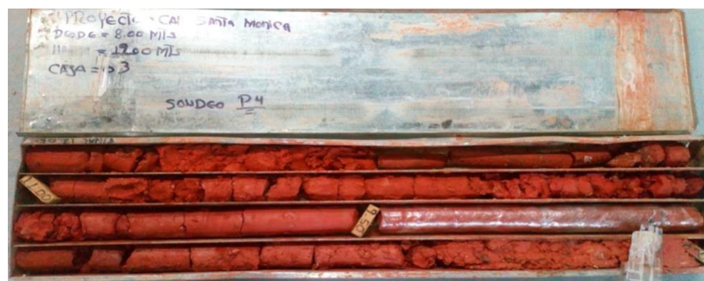
CAJA N°3. Profundidad: 8,00-12,00 m
