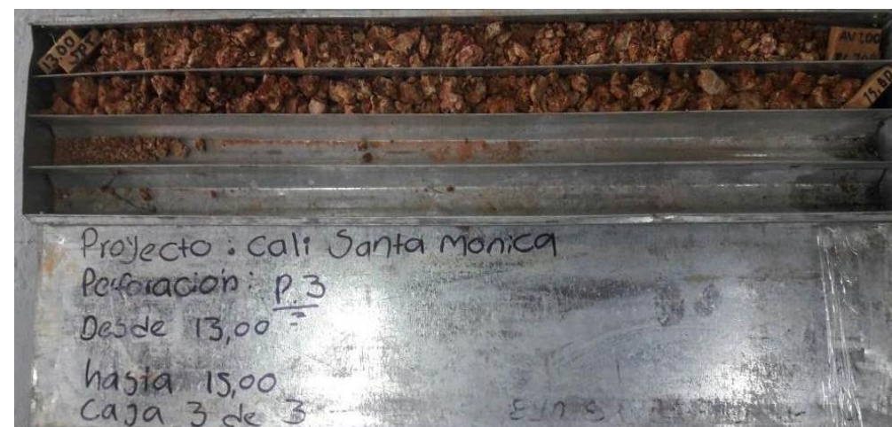
CAJA N°3. Profundidad: 13,00-15,00 m
