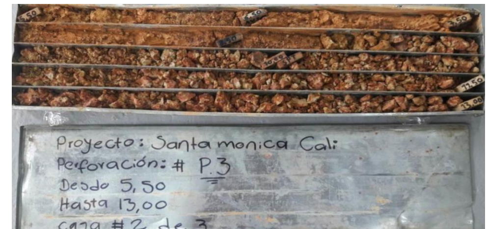
CAJA N°2. Profundidad: 5,50-13,00 m
