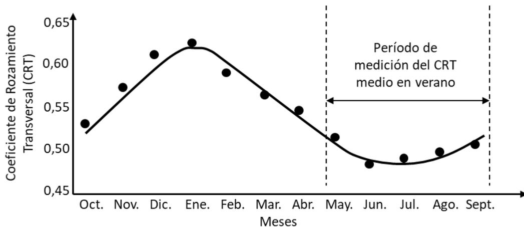
Figura 6. Evolución estacional de la resistencia al deslizamiento.
