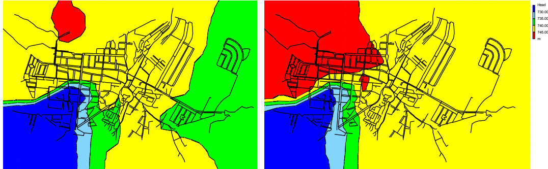
Figura A3-75. Mapas de isótopos de las alturas piezométricas para las 8:00 y 3:00 horas
