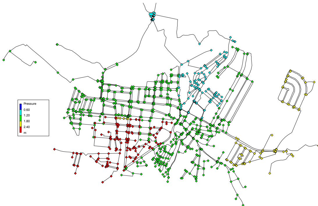
Figura A3-41. Rango de presiones a lo largo de los nudos de consumo para el periodo de simulación
