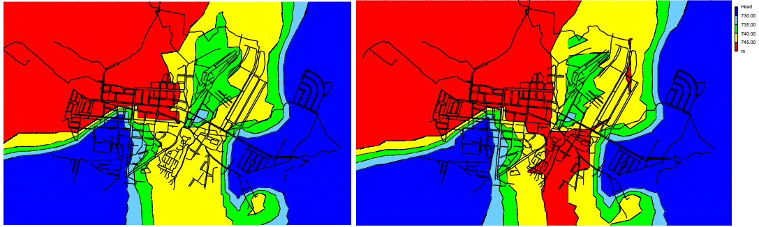
Figura A3-8. Mapas de isolíneas de las alturas piezométricas para las 8:00 y 3:00 horas
