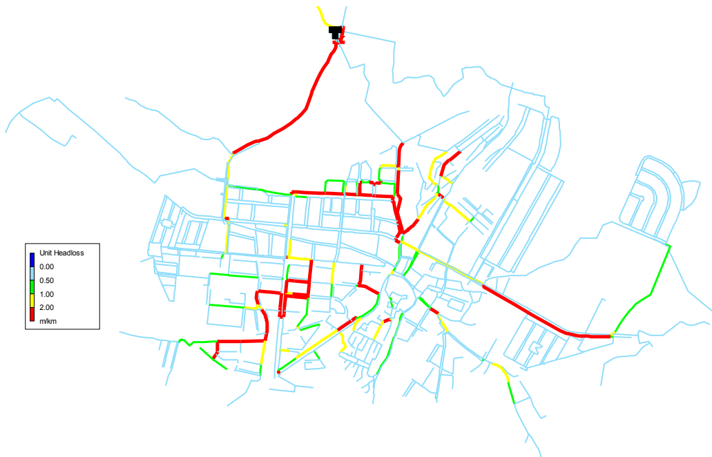
Figura A3-11. Distribución de la altura piezométrica a la hora de mínimo consumo
