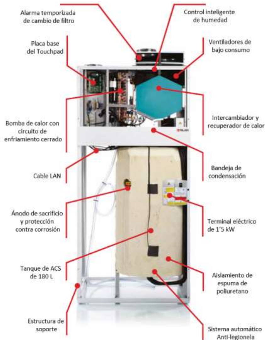
Figura 29. Esquema de funcionamiento Compact P XL.
