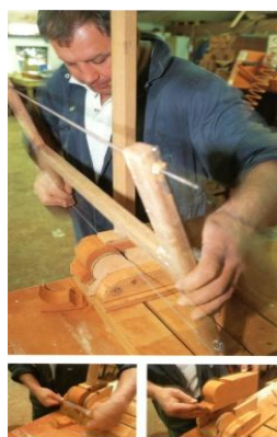
FIG. 91 Corte de ladrillos en un taller artesanal gracias a la guía de una caja de madera con plantillas (CAMBELL-PRICE). Soluciones con ladrillos aplantillado y escafilado para aleros y esquinas, vivienda de la C/ Carniceros (Va104) en Valencia (CRISTINI)
