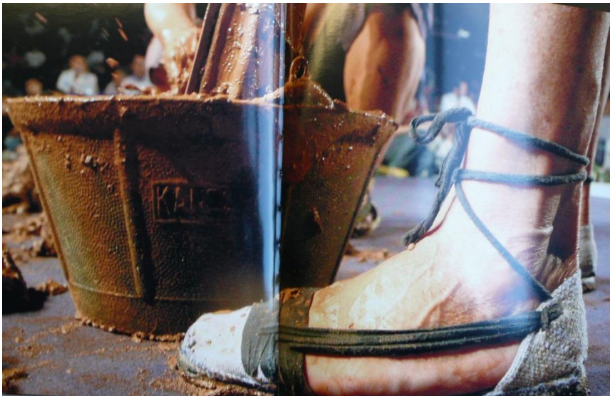
FIG. 48 Munydora y carrega , herramientas básicas del rajolar de Granelles (CORNELLAS)
