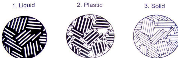
FIG. 17 Variación de las partículas de arcilla en contacto con el agua, durante y después la fase de secado (HOUBEN-GUILLAUD)
