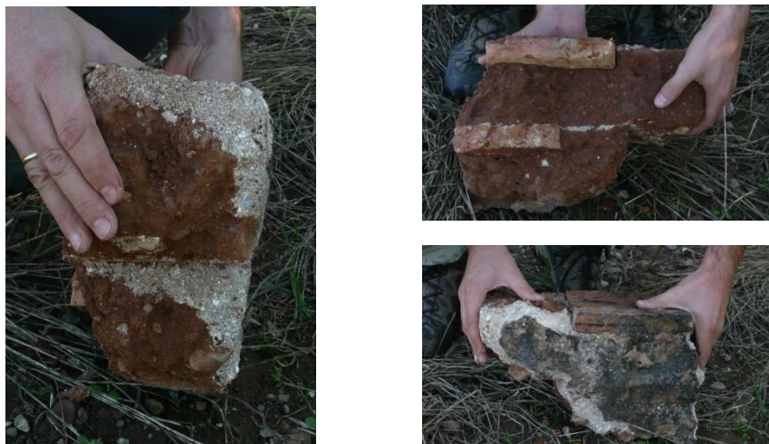
FIG. 136 Detalles de distintos tipos de costras en fábricas de tapia valenciana (CRISTINI)
