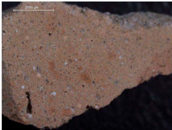
Figura 2 Ladrillo compacto de color rojizo.
