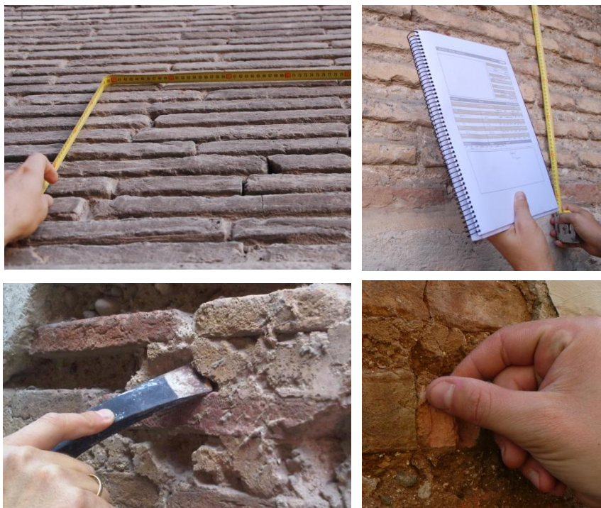
FIG. 22. Mediciones, toma de datos, selección extracción y recogida de muestras de ladrillos y morteros. Análisis empírico in situ (CRISTINI)
