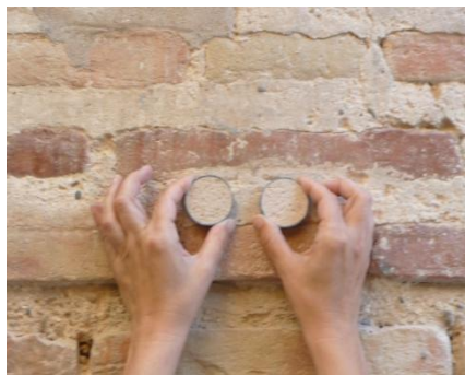
FIG. 129 Pruebas de entonado de morteros, viviendas C/Roger de Flor nº39, Valencia (CRISTINI)
