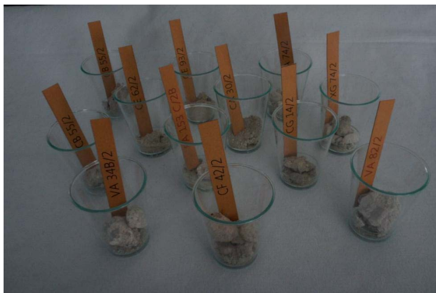
FIG. 82 Clasificación muestras de morteros claros Ca30/2, Cb55/2, Ce62/2, Ce93/2, Cf42/2, Cg14/2, Fa153c/2b, Xa74/2, Xg74/2, Va34b/2, Va82/2 (CRISTINI)
