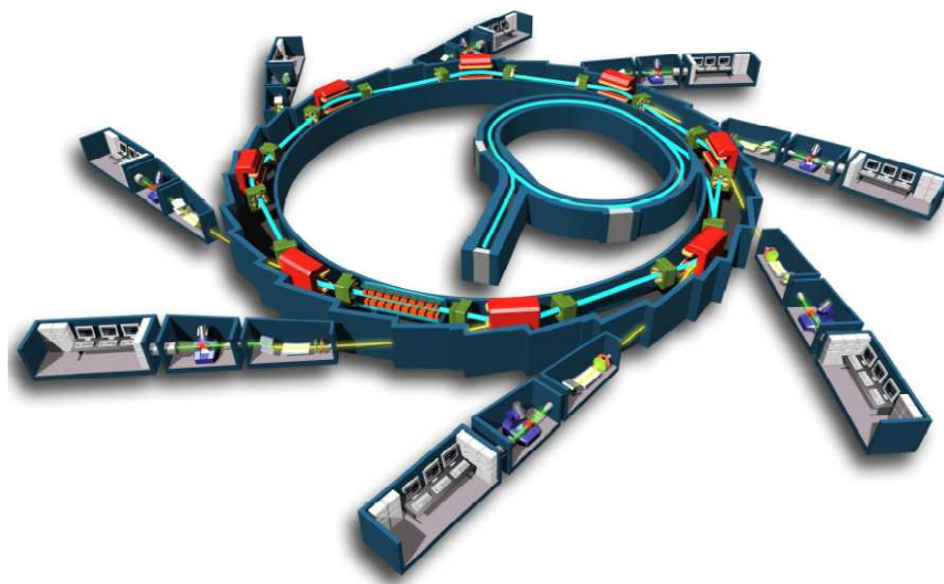
Figura 7. esquema de funcionamiento de una instalación de sincrotrón
