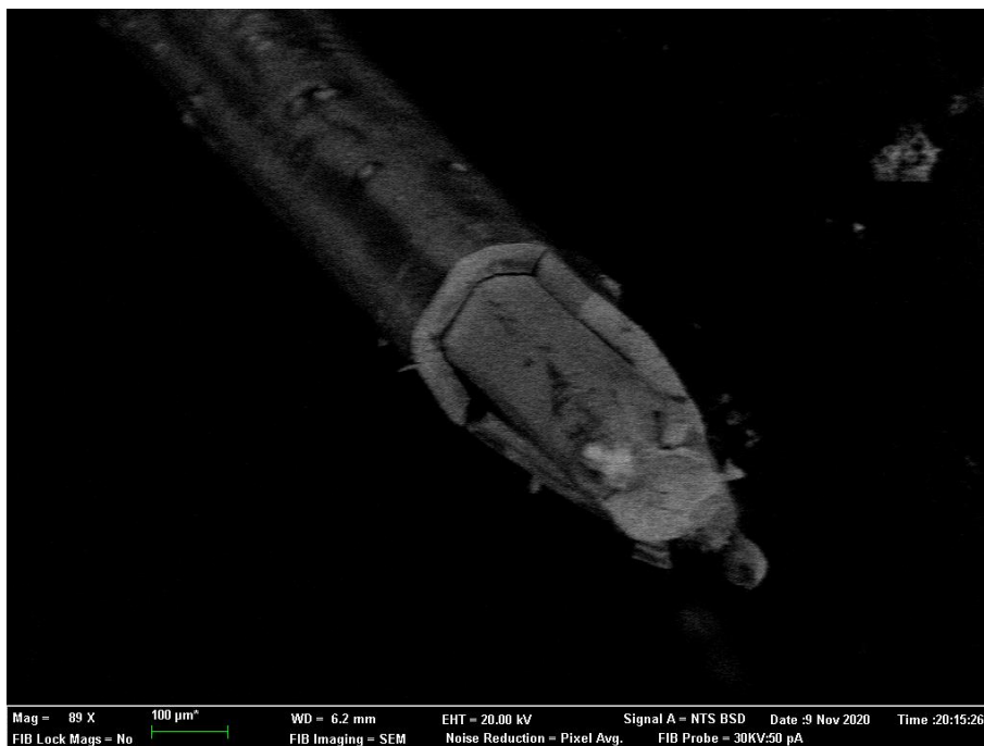
Figura 24. Imagen de EDX. Análisis de conductividad de hilo de cobre recubierto a 7,5 \text{mA}/\text{cm}^2 durante 60 horas. Óxido en la parte superficial (gris oscuro). GaFe en la capa interna.
