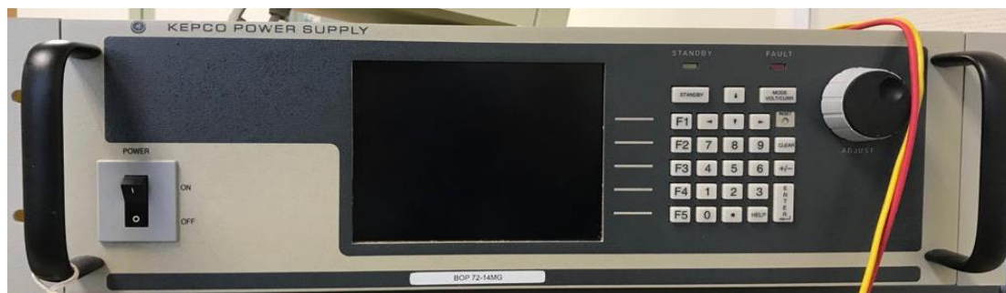
Figura 13. Fuente de corriente utilizada para alimentar la bobina.
