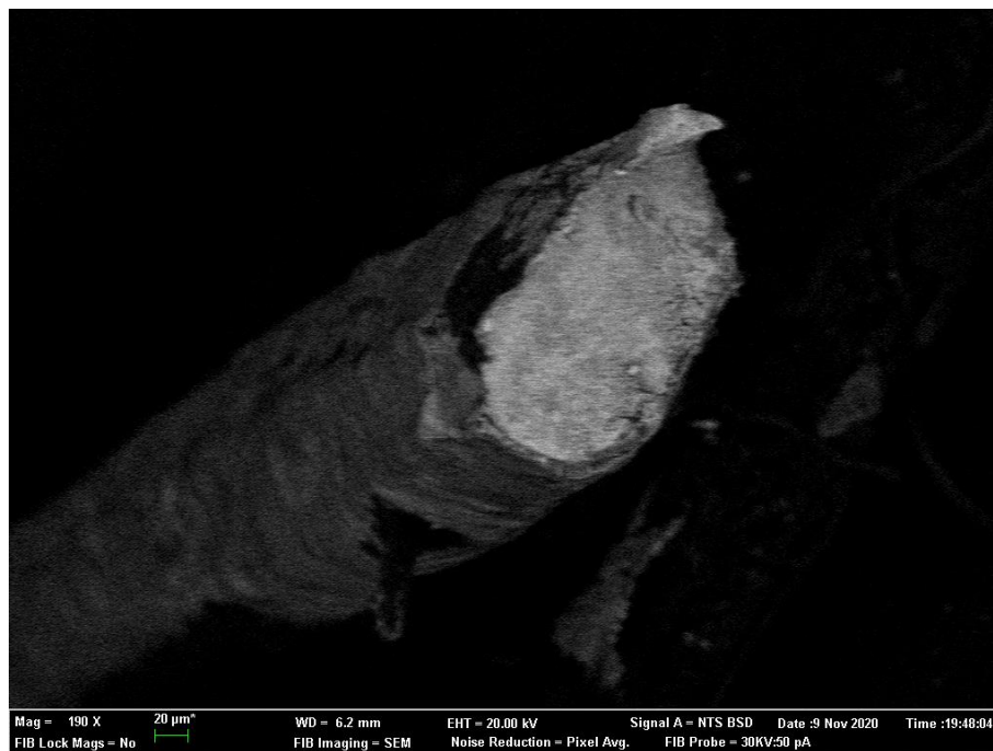
Figura 22. Imagen de EDX. Análisis de conductividad. En gris oscuro se muestran los óxidos depositados, el gris claro únicamente queda el hilo de cobre.
