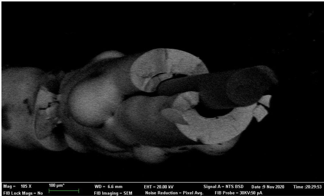
Figura 40. Imagen EDX. Se muestra en gris claro la alta conductividad del recubrimiento, viendo que carece de óxidos. En oscuro la baja conductividad del vidrio.
