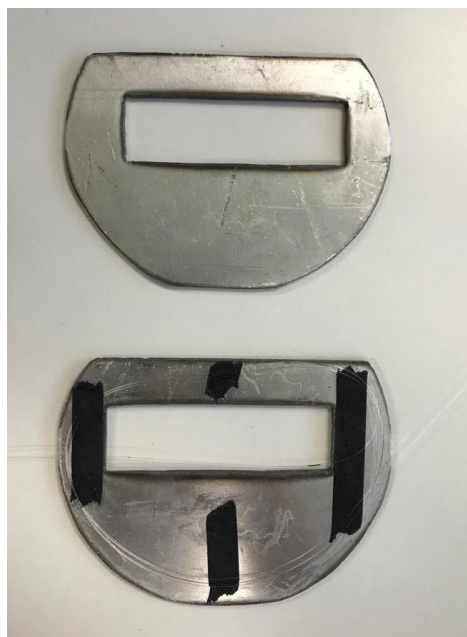
Figura 27. Máscara para hacer Sputtering en las fibras con una ventana de 5 cm para seleccionar la zona a recubrir.
