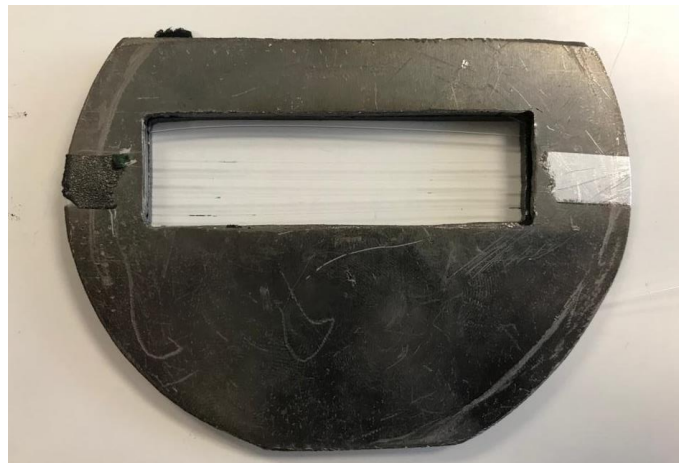
Figura 28. Máscara con 6 fibras peladas y preparadas para el Sputtering.
