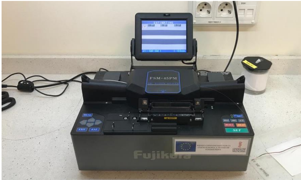
Figura 8. Máquina para dotar de conector las fibras ópticas.
