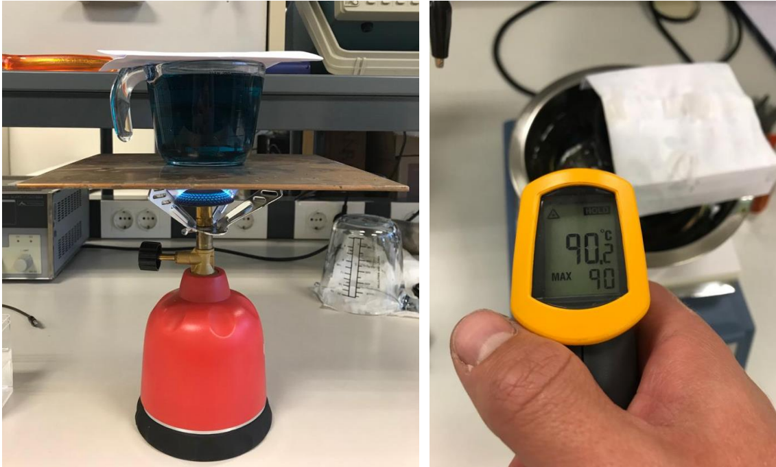
Figura 30. Infiernillo para la deposición química de Níquel y termómetro láser para mantener la temperatura a 90°C.
