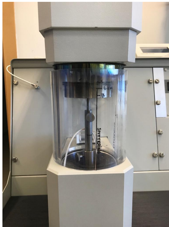
Figura 4. Zona de trabajo de la máquina de Sputtering UPV Leica EM MED020.
