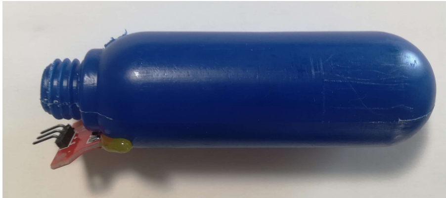
Figura 20: Depósito de líquido fumígeno con sensor de nivel de líquido en su interior
