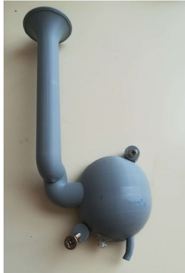
Figura 15: Concentrador de humo impreso en 3D
