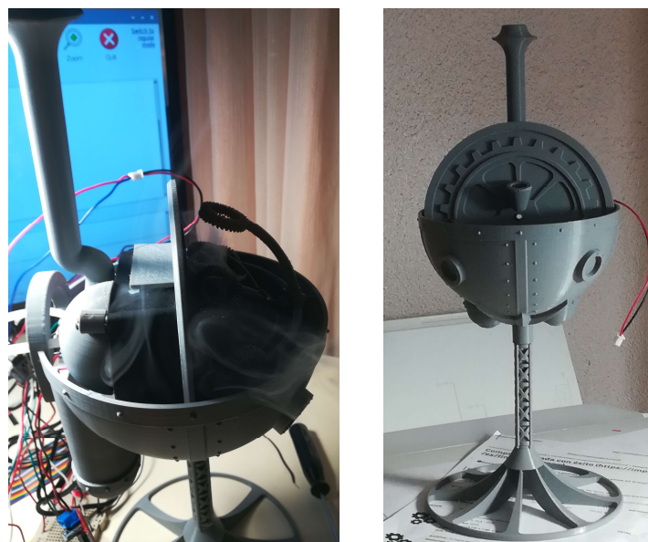
Figura 48 y 49: Montaje y prueba del concentrador de humo
