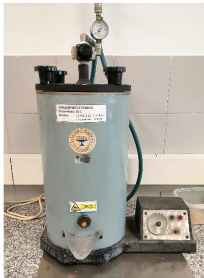
*Ilustración 68. Inyectora de cera*
