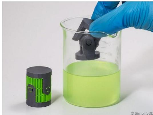
Ilustración 36. Pieza con soportes HIPS
