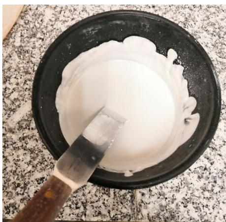
*Ilustración 113. Preparado de revestimiento cerámico*
