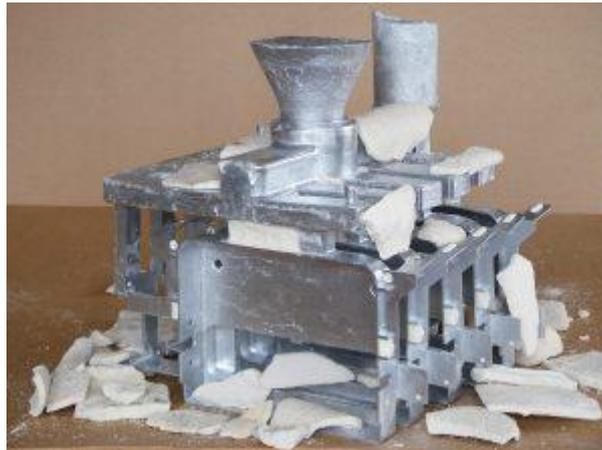
*Ilustración 9. Rotura del molde*
