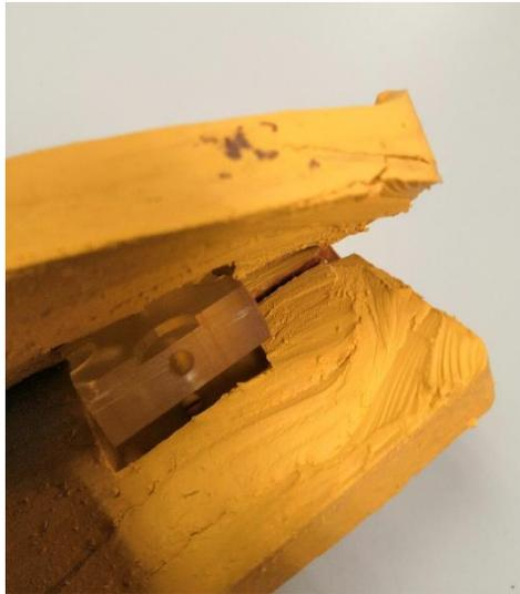
*Ilustración 99. Molde de goma vulcanizada con pieza*
