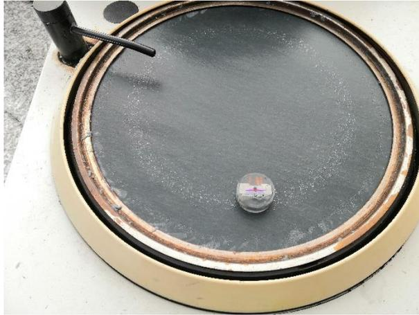
*Ilustración 133. Probeta en pulidora*
