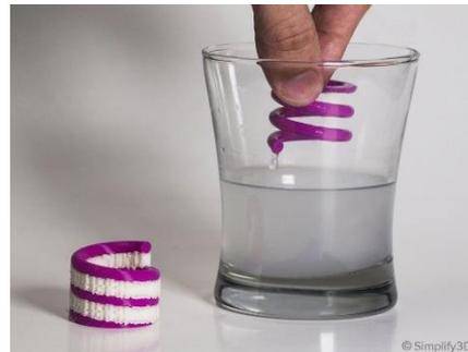
Ilustración 33. Pieza con soportes PVA
