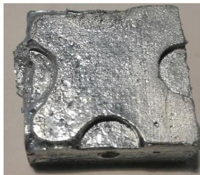
*Ilustración 111. Pieza metal molde cera*
