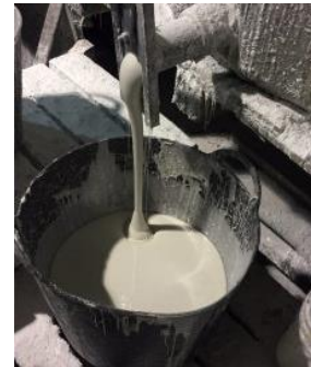
Figura 270. Proceso mezcla de resinas con minerales
