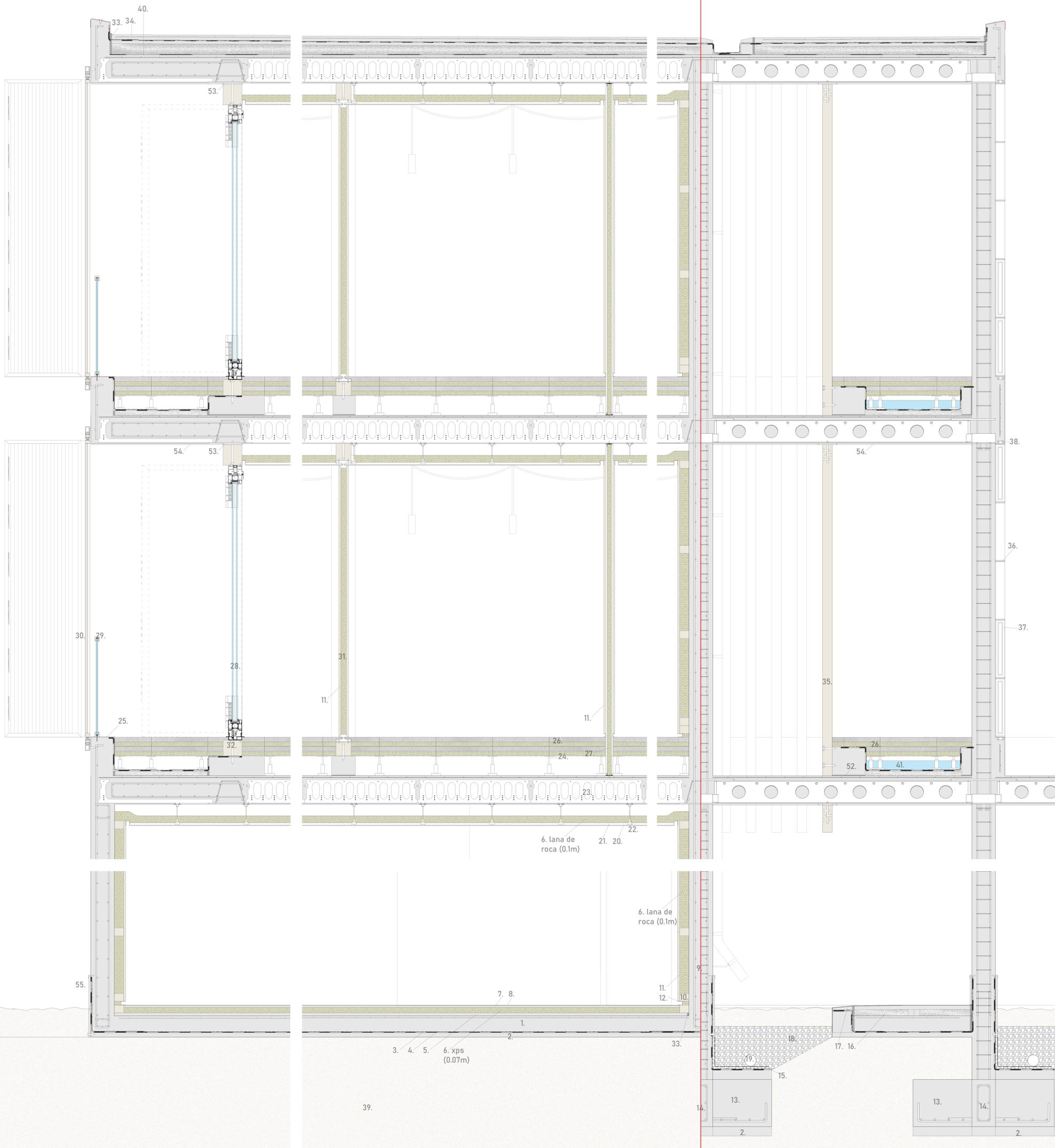
1. SOLERA. hormigón armado. 0.30m
