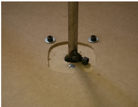
ilustración 14/15 – sistema de enganche al eje motor
