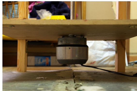
ilustración 14/15 – sistema de enganche al eje motor
