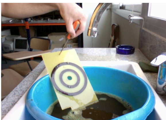
ilustración 8 – proceso químico de revelado
