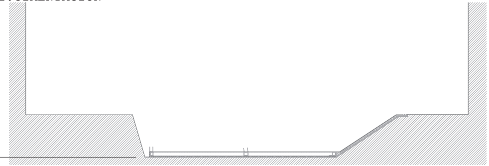
Losa de cimentación. Cota de cimentación -5,50m.
