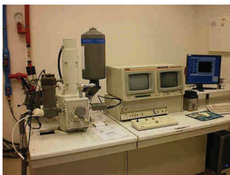
Figura III.4. Cryo-Trans CT1x500C de Oxford Instruments acoplado a un microscopio electrónico de barrido JEOL JSM 5410 (cryo-SEM).
