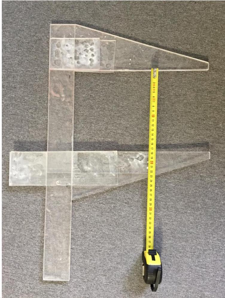
*Figura 149.* Pie de rey para grandes proporciones. La especificidad del trabajo determina a veces la inexistencia de herramientas adecuadas siendo necesario su diseño y fabricación propios. Fuente propia.
