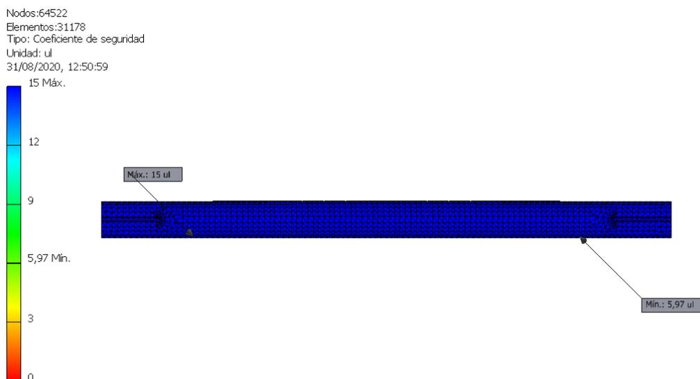
Figura 76. Estudio con MEF. Representación del coeficiente de seguridad
