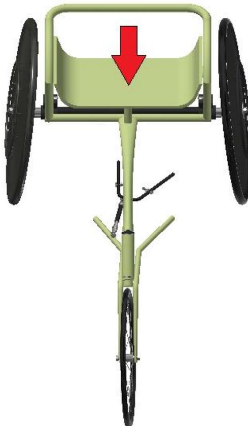
*Figura 65. Representación de la carga puntual aplicada*
