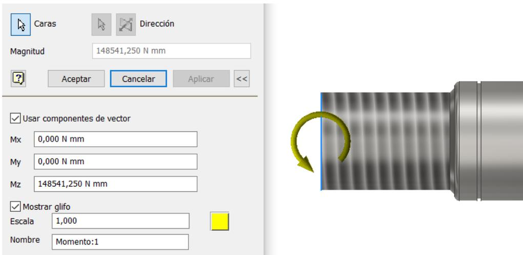
Figura 68. Momento aplicado en el eje de la rueda trasera
