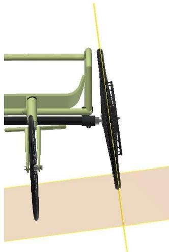
*Figura 51. Vista de la restricción de la rueda trasera con el plano inclinado*
