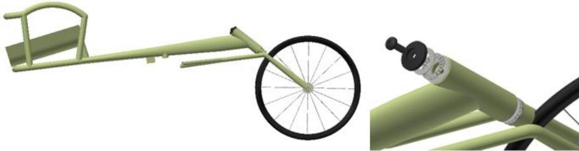
*Figura 48. Montaje de los rodamientos con el manillar y el chasis*
