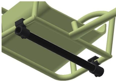
*Figura 49. Montaje de la barra principal trasera y las abrazaderas*
