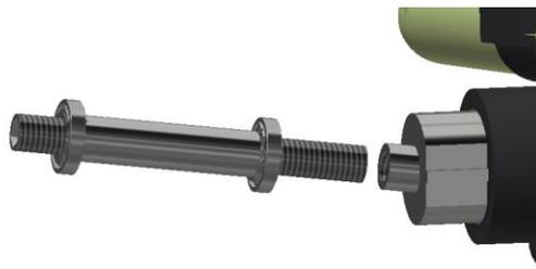
*Figura 50. Montaje del eje de la rueda trasera con rodamientos*
